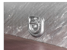
Kraftiga invändiga bindöglor
