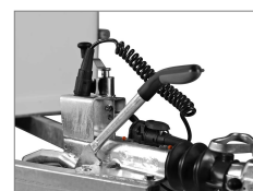
13-polig löstagbar spiralkabel
