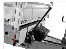
Elektrisk tipp åt tre håll
