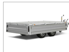
Fällbara och avtagbara lämsidor och hörnstolpar
