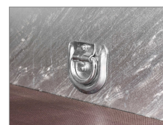
Kraftiga invändiga bindöglor
