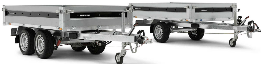
Fällbara och avtagbara lämsidor och hörnstolpar
