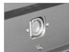
Kraftiga invändiga bindöglor
