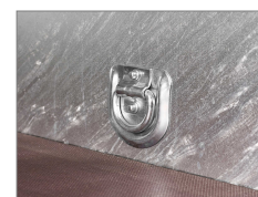
Kraftiga invändiga bindöglor
