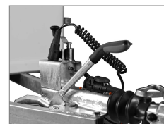
13-polig löstagbar spiralkabel
