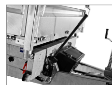
Elektrisk tipp åt tre håll
