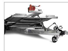
Manuell-hydraulisk tipp och vinsch
